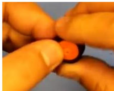
2. Monter le pneu sur l'axe de la machine de rodage et dévissez la vis de butée au maximum
