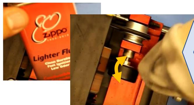
6. Dégagez le pneu de la bande abrasive. Imbibez un chiffon avec de l'essence à Zippo. Mettez la roue en rotation et travaillez le pneu en balayant d'un coté à l'autre. Le pneu doit devenir brillant.
