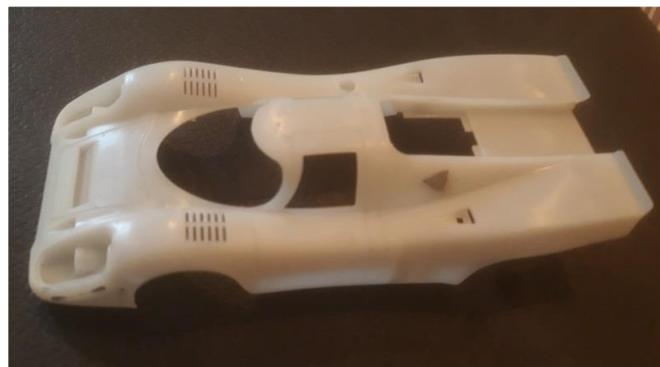
Obturation au mastic Tamiya des prises d'air NACA du capot arrière, (attention au retrait du produit).
