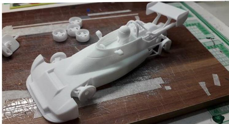
Il faut ajuster un peu la fenêtre de la couronne, sous la voiture, pour fluidifier la transmission, et poncer un peu la carrosserie, pour éviter le phénomène de 'strates' laissée par l'imprimante.
