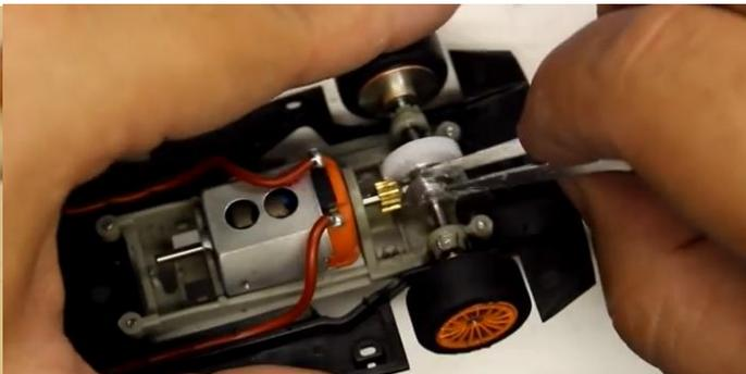
3. Mettre en place la carrosserie et la visser à l'aide des deux vis : visser pour arriver en butée, puis dévisser d' ½ tour environ pour laisser de la liberté au châssis, pour ne pas le contraindre et perdre les effets du redressage. Contrôlez le jeu avant/arrière.
